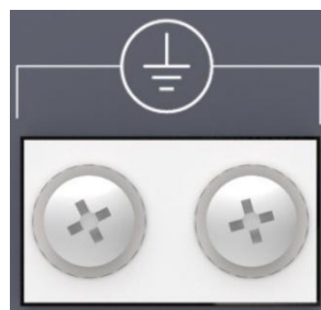
图 3.5 伺服驱动器接地端
